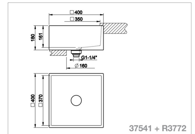
Lavabo da sottopiano in Ceramica Bianco Europa senza scarico troppopieno. Piletta con tappo in ceramica incluso. Per installazione sottopiano necessario kit di fissaggio art. R3772.
