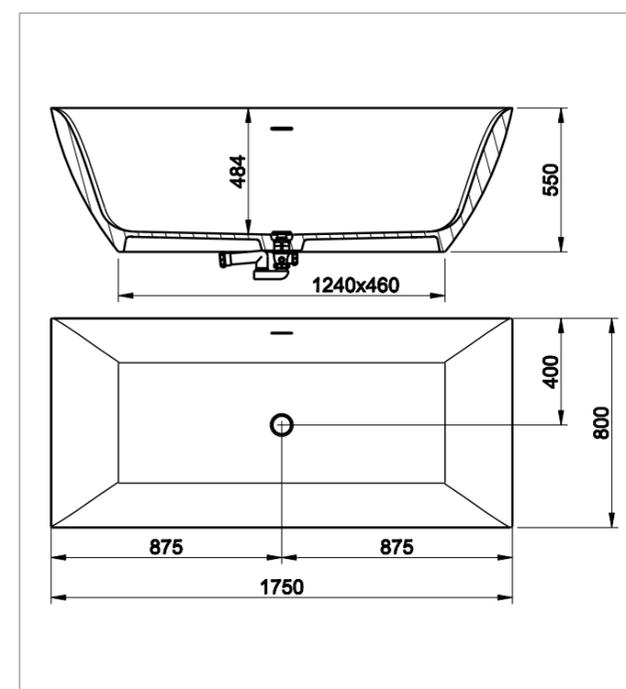
Vasca da bagno freestanding in Ceramilux, completa di piletta con sistema di scarico a pressione click-clack.
