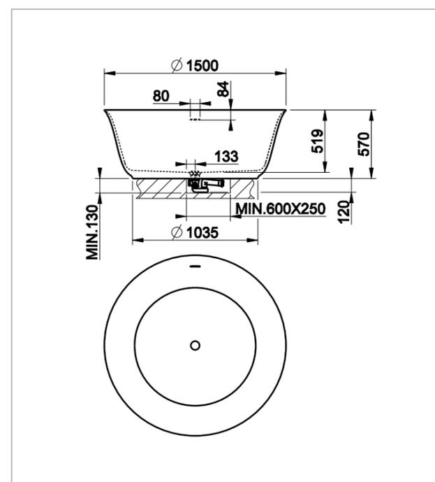
Vasca da bagno freestanding in Cristalplant, completa di piletta con sistema di scarico a pressione click-clack.
