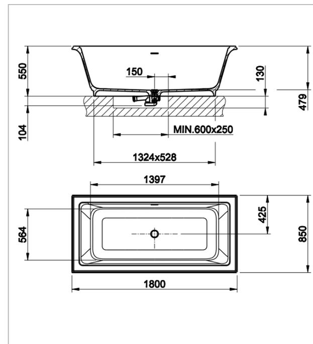
Vasca da bagno freestanding in Cristalplant. Completa di piletta con sistema di scarico a pressione click-clack. **46717** Su richiesta possibilità di verniciatura esterna.
