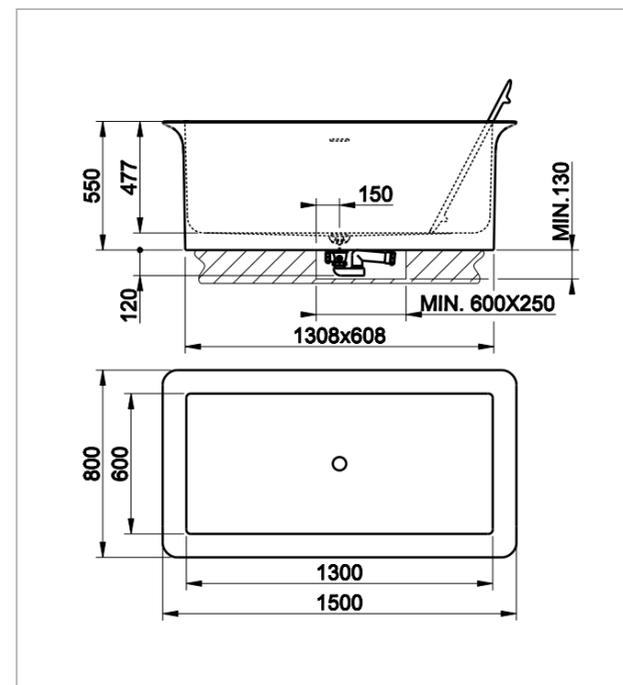
Vasca da bagno freestanding in Cristalplant, con accessorio multifunzione poggia schiena/mensola. Completa di piletta con sistema di scarico a pressione click-clack.
