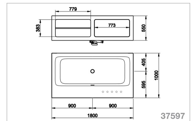
Vasca da bagno freestanding in Cristalplant con bordo laterale. Vani a giorno (destra) e installazione rubinetteria bordo vasca con sportello per ispezione (sinistra). Completa di piletta con sistema di scarico a pressione click-clack.
