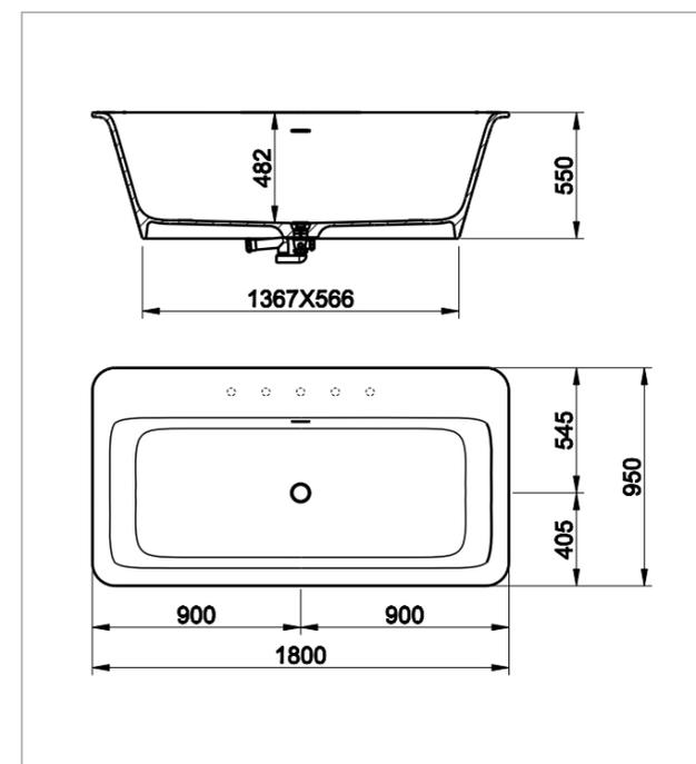
Vasca da bagno freestanding in Cristalplant con bordo laterale. Possibile installazione rubinetteria bordo vasca. Completa di piletta con sistema di scarico a pressione click-clack. **37592** Su richiesta possibilità di verniciatura esterna.
