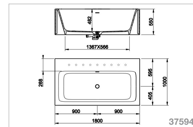
Vasca da bagno freestanding in Cristalplant senza bordo laterale. Completa di piletta con sistema di scarico a pressione click-clack.
