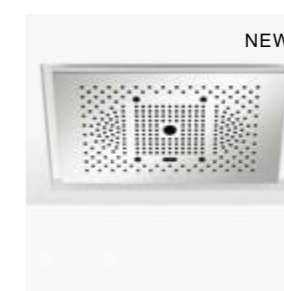
41 781 979 2 SERENITY SKY Rain panel for ceiling installation or ceiling substructure installation SERENITY SKY Rain Sky pannello per installazione ad incasso in controsoffitto o a soffitto SERENITY SKY Panel de lluvia con fijación a techo [44,4 l/min.]
